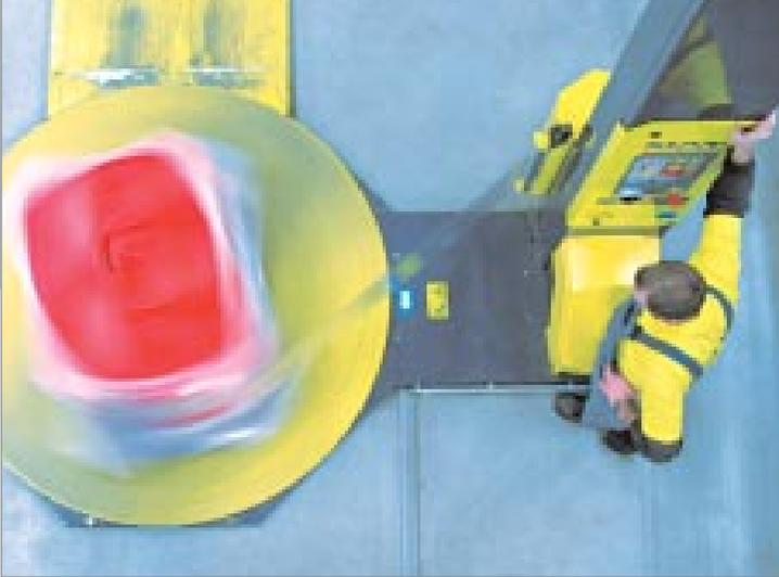
Ein Knopfdruck und die Stretch-Maschine verpackt und schützt die Ware für den Versand.
